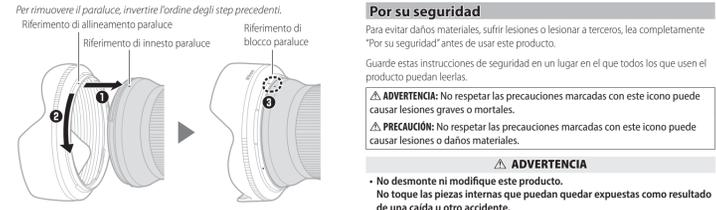
Quando si collega o si rimuove il paraluce, mantenerlo in prossimità del riferimento di allineamento paraluce **1** e evitare di impugnare con troppa forza la parte anteriore del paraluce. Il paraluce può essere invertito e innestato sull'obiettivo quando non è in uso.
